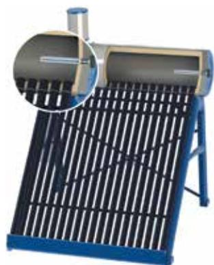
Безнапорная система RNB-Нерж с баком из нержавеющей стали. Передача тепла в данной системе осуществляется благодаря естественной конвекции, что делает систему доступной, а так же простой в монтаже и в обслуживании.
