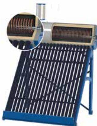
Напорная система RPA-Теплообмен, в которой нагрев осуществляется при протоке воды через медный теплообменник, находящийся в баке. Контур протока воды полностью герметичен и позволяет работу под давлением.
